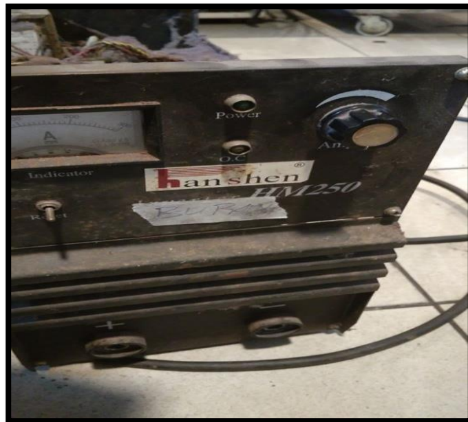
Gambar 4.32 Pemutar Volume Arus Listrik Yang Rusak
